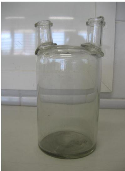
Figura 11 - Frascos de vidro com duas bocas para destilação. Foto: Maria Lucia M de Carvalho, 2015.
